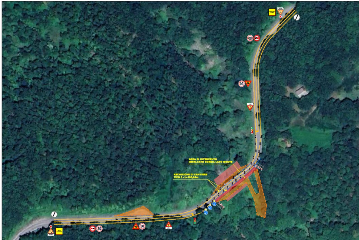
Fig. 4.1.2 – Fase 02-03 – Chiusura viabilità corsia sud lato monte
