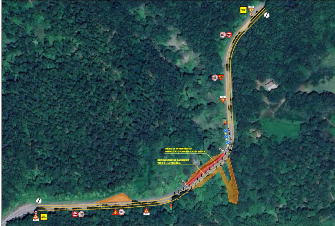
Fig. 4.1.4 – Fase 04-05 – Chiusura viabilità corsia nord lato valle
