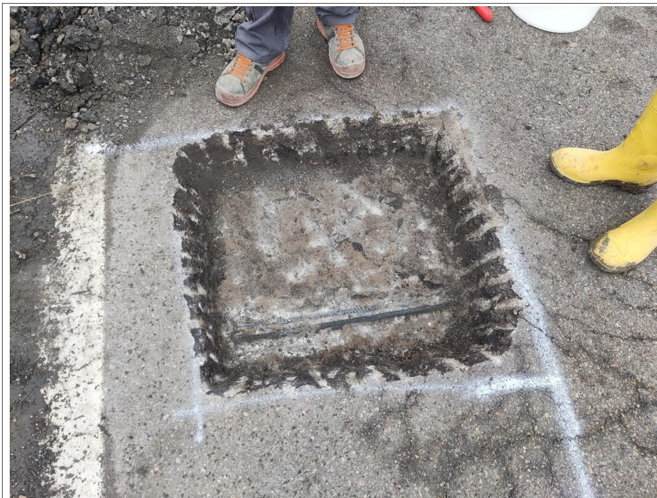
Figura – Rilievo ferri delle soletta
