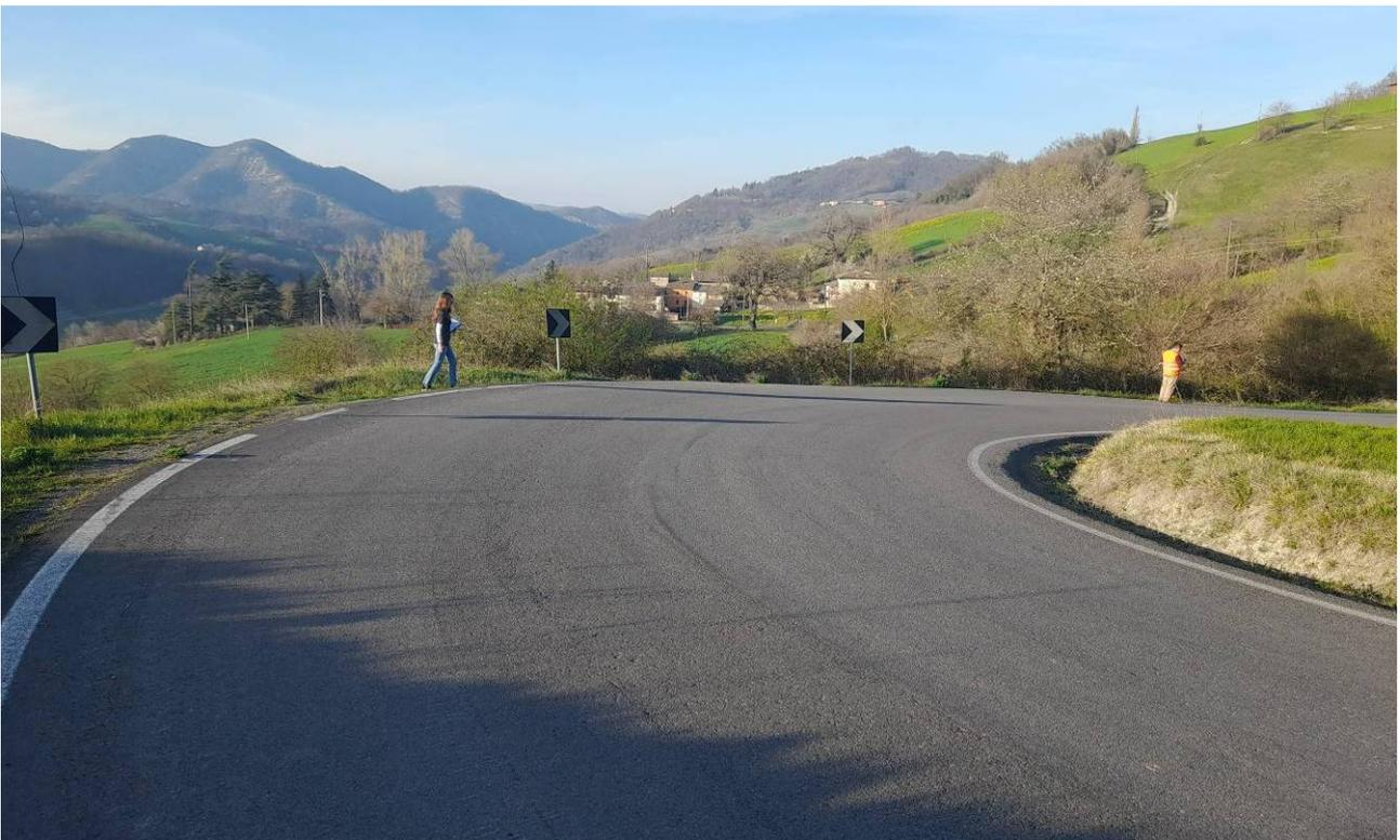
**Fig. 5 – Vista della curva al km 1+050 in cui la pendenza del tratto stradale è dell'ordine del 9%; si nota l'assenza dei sistemi di ritenuta.**
