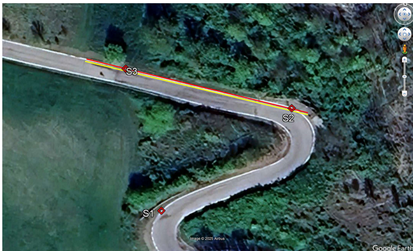
Figura 3. Dettaglio area in esame e ubicazione indagini geognostiche pianificate. (Vedasi tabella nel paragrafo successivo). Indicati n° 3 sondaggi geognostici di profondità di 20 m ciascuno, stendimento di sismica a rifrazione (in giallo) e stendimento MASW (in rosso).
