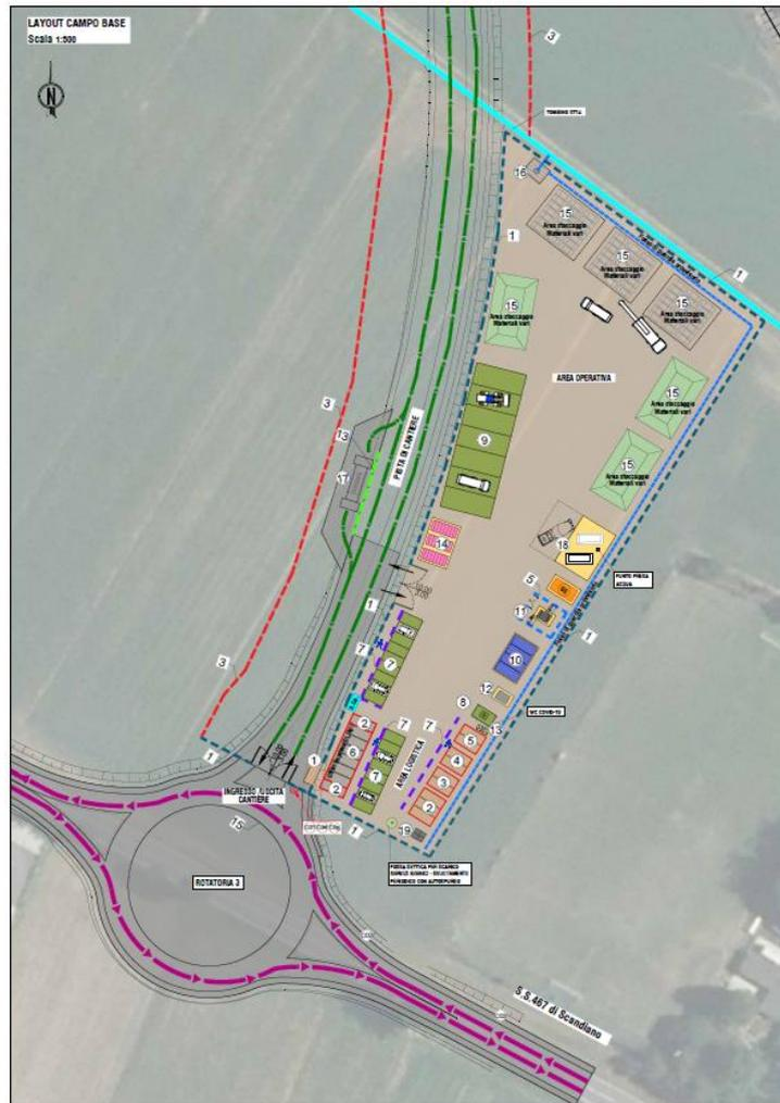
Figura 3.4 Layout Cantiere Base
