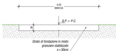
Figura 5.5 – Sezione tipologica pista di servizio lungo linea
