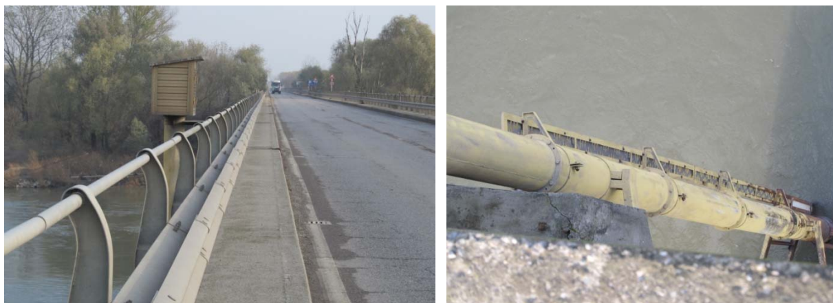
Figura 9.16: – idrometro AIPO presente sul lato di valle del ponte, al centro dell'alveo di magra
