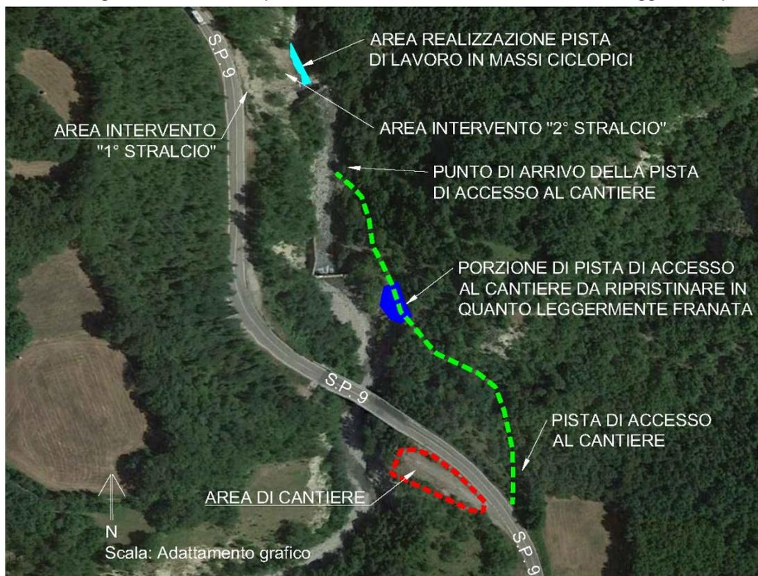
Foto 4- Particolare della pista di accesso all'area di cantiere esistente oggetto di ripristino.
